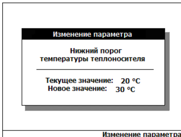
Рисунок 3.9 – Изменение значения нижнего порога критической температуры теплоносителя
