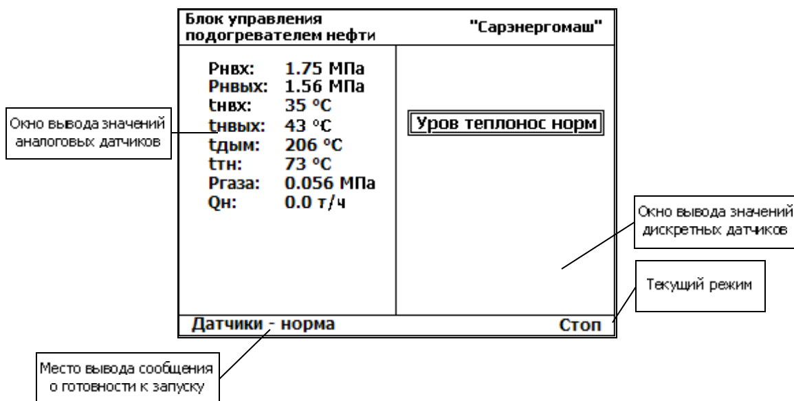
Рисунок 3.1 - Внешний вид экрана ЖКИ подогревателя в режиме «СТОП», готовый к запуску
